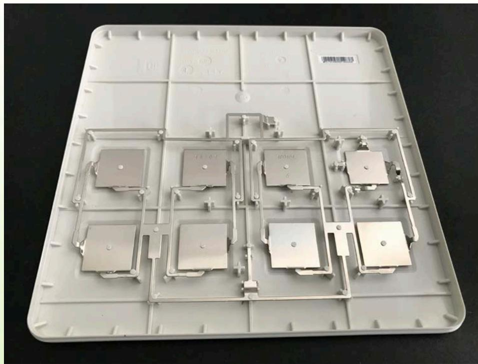
通讯终端用零部件，平山进行冲压，表面处理，热熔，条形码，测试等多次工序
